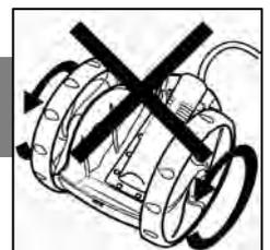
**1** Le robot est équipé d'un dispositif de sécurité qui coupe automatiquement le robot s'il démarre hors de l'eau. Pour les piscines ayant une plage immergée, ce dispositif de sécurité permet au robot de faire demi-tour et de retourner dans le bassin.
