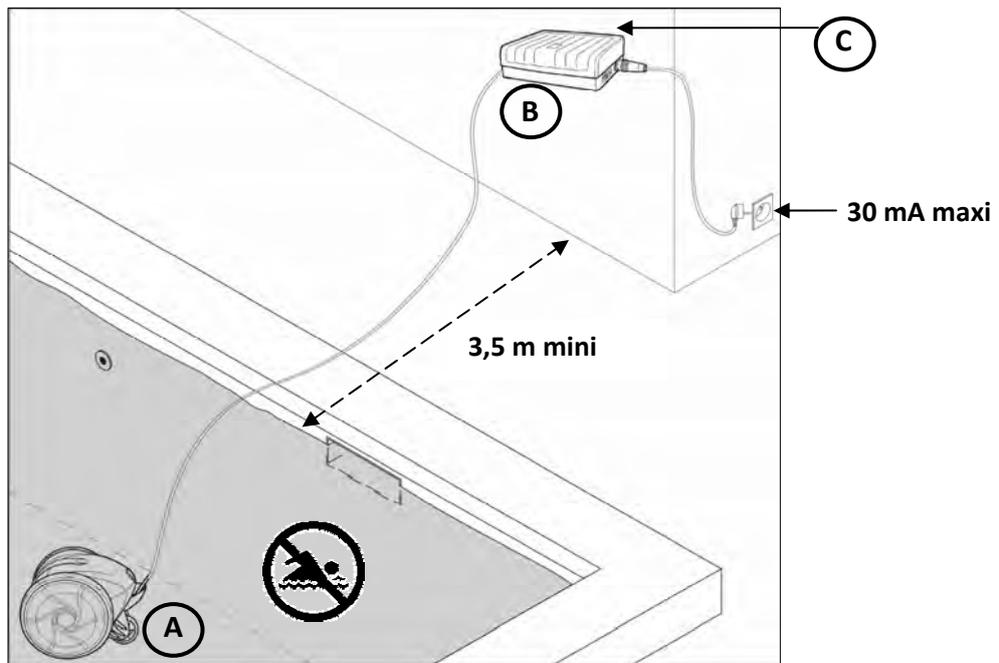
**i** Possibilité de poser le boîtier de commande au sol à 3,5 mètres minimum du bord de la piscine
